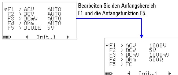
**Abbildung 4-27** Bearbeiten von Anfangsmessfunktion/-bereich
