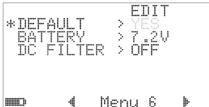
Abbildung 4-30 Zurücksetzen auf Standardwerkseinstellungen
